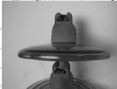
Figura 3. Foto Ilustrativa de una Cadena de Aisladores de Vidrio, con el Detalla de Acople
